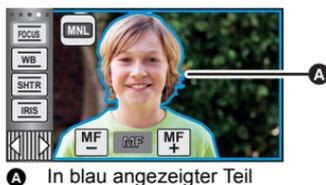
Der scharfgestellte Bereich wird in blau angezeigt. Die normale Anzeige kehrt ca. 2 Sekunden nach der erfolgreichen Scharfstellung des Objekts zurück.
